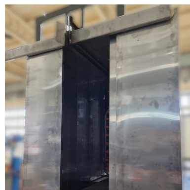
Die Breite der Einfahrt zur Waschanlage wird durch Schiebetüren reguliert
